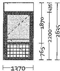
Porta ad 1 anta U.S. ad apertura esterna, (vista interna senso di apertura spingere dx), con pannello cieco liscio fino ad h 800mm circa, maniglione antipanico ad 1 punto di chiusura con maniglia esterna, soglia bassa h 20mm, vetri stratificati interno/esterno 33/18/33 completa di controtelaio in ferro zincato
